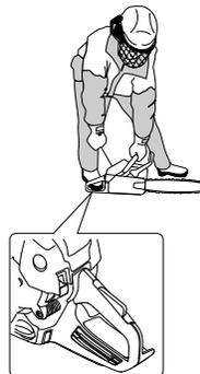
Da die Kettenbremse immer noch eingeschaltet ist, muss die Motordrehzahl so schnell wie möglich auf Leerlauf herunter, was durch ein schnelles Ausschalten der Gassperre erreicht wird. Dadurch vermeiden Sie
