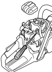
Bei Temperaturen unter -5 °C und/oder Schnee kann auf dem Startvorrichtungsgehäuse eine spezielle Abdeckung montiert werden.
